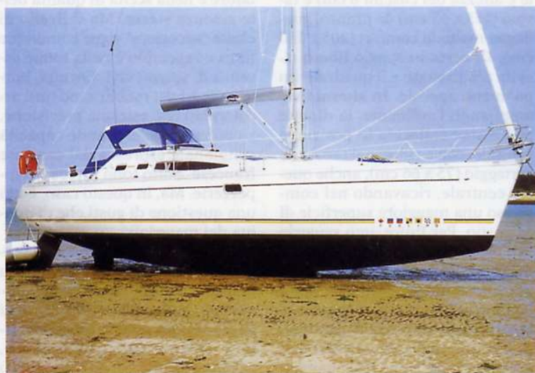
L'immersione del 39 a deriva alzata è di soli 70 centimetri, un vero dériveur intégral .
